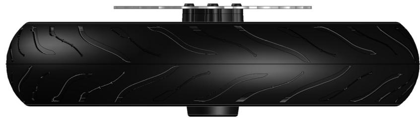
1. Lege das Vorderrad flach auf eine Arbeitsfläche, so kannst du die Schrauben der Bremsscheibe am besten lösen (siehe Bild 1).
