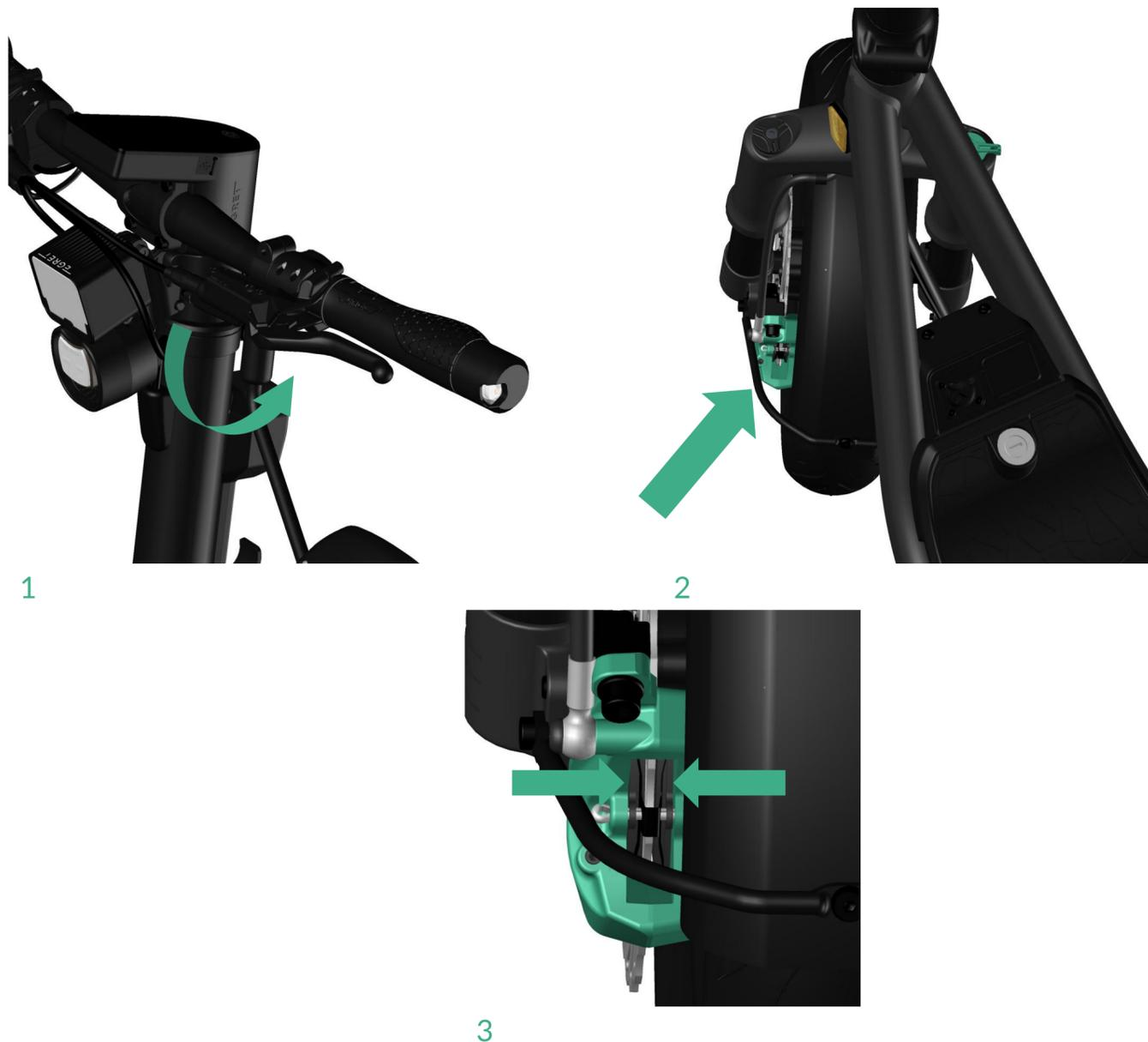
1. Ziehe nun die den linken Bremshebel für die Vorderradbremse fest an (siehe Bild 1). Wenn du dafür den Lenker etwas nach rechts einschlägst (siehe Bild 2) kannst du erkennen, wie sich der Bremssattel bewegt. Wiederhole den Vorgang 1 – 2 Mal.
